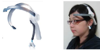
圖 3-2 腦波偵測儀器與佩戴方式
